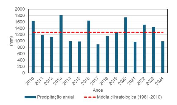
**Figura 9:** Totais anuais de precipitação no período 2010-2024, referentes à estação pluviométrica código 2242010, localizada no município de Maricá-RJ. Fonte: Hidroweb – ANA.
